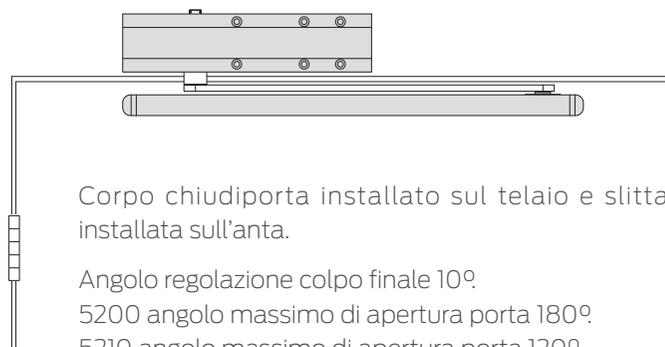
Corpo chiudiporta installato sul telaio e slitta
