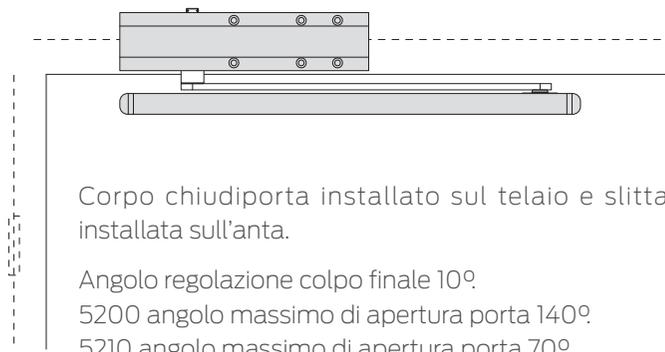
Corpo chiudiporta installato sul telaio e slitta
